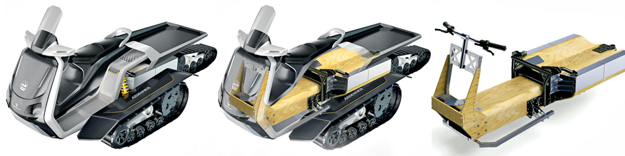
Beim „Mattro“-Schneemobil wurde der Stahlrahmen mit Holz ersetzt und so 140 kg Gewicht eingespart. Foto: U. Müller
