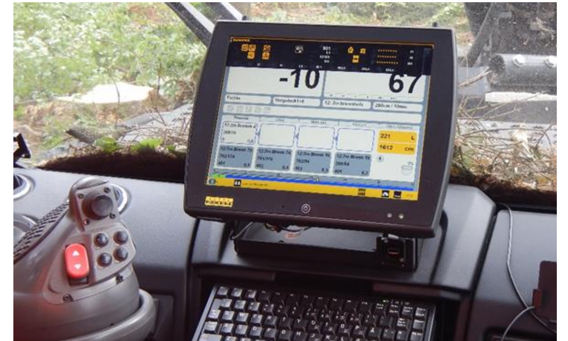
Abbildung 2. Mess- und Steuersystem eines Harvesters
